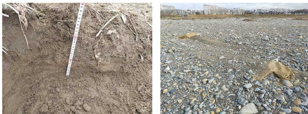
写真 2-4-4 粒径の小さい材料の堆積（左：河岸側、右：水際）
