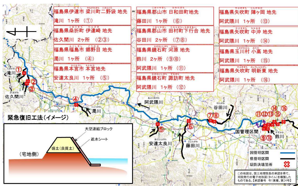
図 2-1-17 台風 19 号による阿武隈川（福島県区間）の堤防緊急復旧実施箇所
