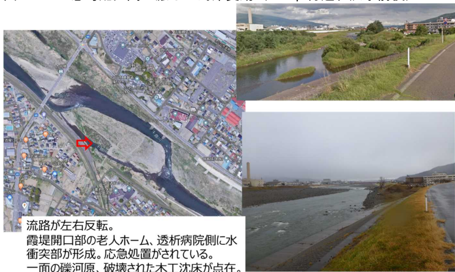
図 2-3-7 急勾配区間の激しい河床変動（102kp 古川橋付近、洪水前後）
