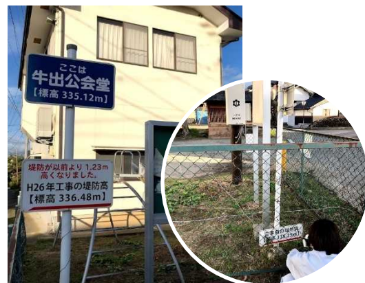
図2-3-23 中野市牛出地区に掲げられる看板、新・旧堤防の高さを記載。
