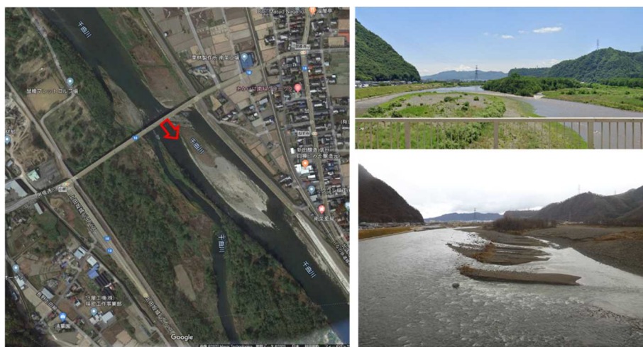
図 2-3-8 急勾配区間の激しい河床変動（98kp 鼠橋上流、洪水前後）
