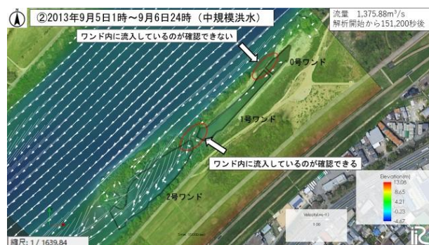
図-1 解析開始から151,200秒後の水の流れ
