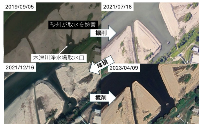
図1 木津浄水場取水口周辺で繰り返される掘削と土砂の堆積
